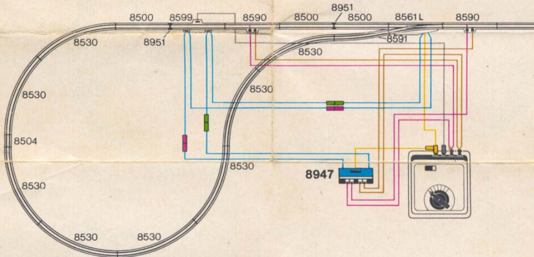
**Automatische Kehrschleifen - Steuerung durch 8947**
