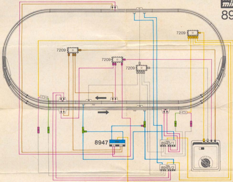
Umpolsschalter 8947 steuert automatischen Zweizugbetrieb mit Gegenverkehr.
