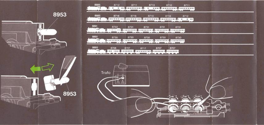
Die Lokomotive ist mit Funk-Entstörmitteln ausgestattet, die im Zusammenwirken mit den in den Märklin-Transformatoren 6711 bzw. 6731 und im Anschlußgleisstück 8590 eingebauten Störschutzelementen das Einhalten der Bestimmungen von VDE 0875 gewährleisten. Sollten beim Betrieb der Spielzeuganlage, z. B. wegen zu geringem Abstand gegenüber der Empfangsantenne oder bei Abweichungen vom vorgegebenen Aufbau der Verkaufspackung,
